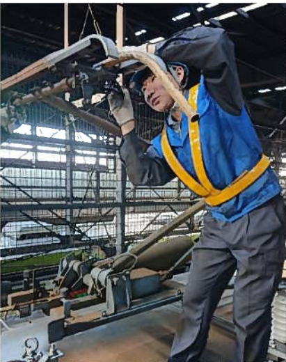
車両検修作業（パンタグラフ擦り板交換作業の様子）
