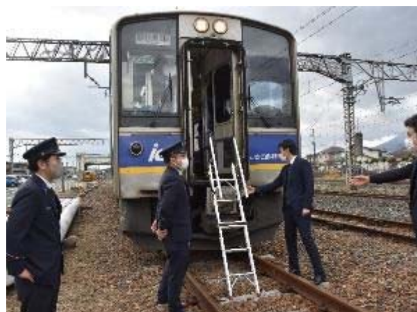
【お客さま避難のための梯子を設置】
