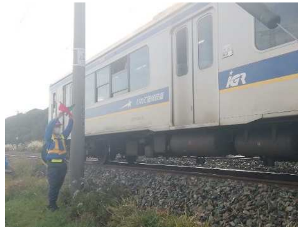
【仮復旧後、手信号により現場通過】 (列車抑止手配訓練)
