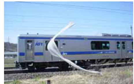
架線に飛来した農業用ビニール
