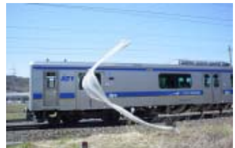
架線に飛来した農業用ビニール
